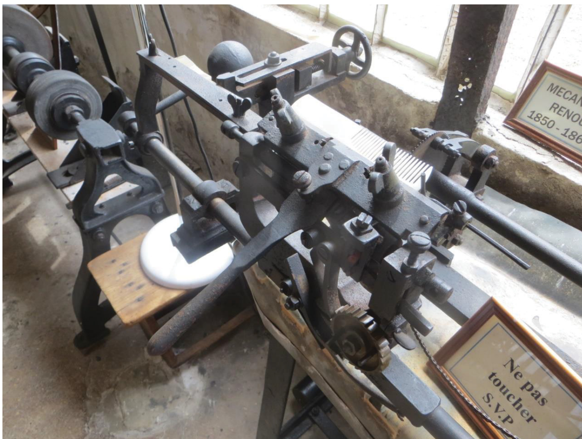
Figure 74. Machine à denter Renout des années 1850. Musée-Manufacture d'Ezy, (photographie de Bruno Evans, 27 juillet 2019)
