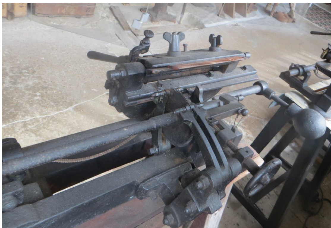
Figure 73. Détail d'une machine à denter (vers 1840-1850), Musée-Manufacture d'Ezy, (photographie de Bruno Evans, 27 juillet 2019)
