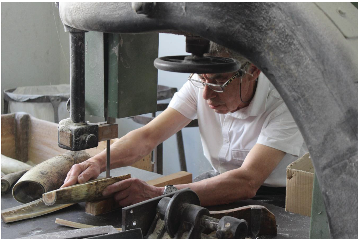
Figure 85. Découpe de la corne en plaques au moyen d'une scie à ruban par Jean-Pierre Azéma-Bigou. Cliché Bruno Evans, 10 juillet 2013
