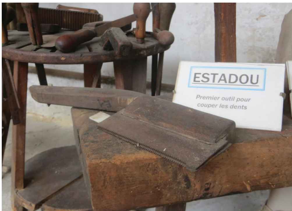
Figure 72: Estadou, scie à deux lames servant à tailler les dents du peigne. (Manufacture-Musée du peigne d'Ezy-sur-Eure, cliché Bruno Evans, 27 juillet 2019). À ma connaissance, il s'agit du seul modèle d'estadou que l'on puisse encore voir.
