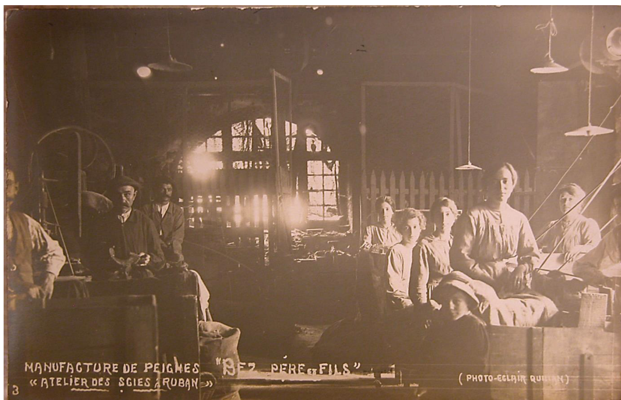
Figure 77 Atelier des scies à ruban de l'usine Bez vers 1920 (AP Bez-de Faucher). 1 re étape du travail du peigne : le découpage des cornes en trois tronçons, dont le central (le biscage) est ouvert.
