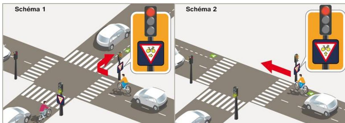
Figure 3 : Schéma d'utilisation d'un Cédez-le-Passage Cycliste ; Source : Ville de Paris.
