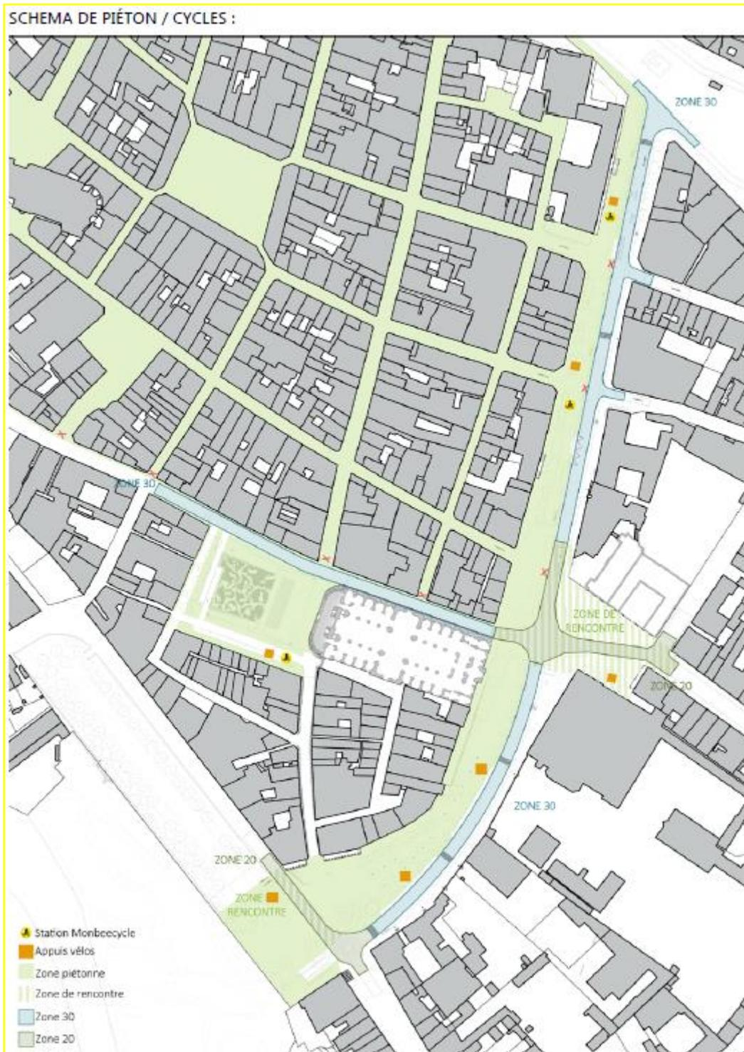
Figure 39 : Schéma de la zone piétonne du projet d'aménagement du cœur de ville. Source : Grand Montauban
