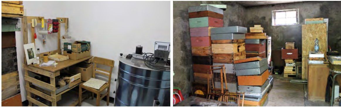
Photo 36 : Miellerie (Ariège). Aménagement intérieur. Photographie 1 : chambre d'extraction, avec désoperculateur à gauche ; photographie 2 : espace de stockage des ruches (O.R., 2022).
