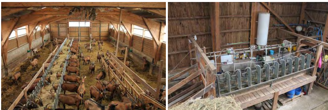
Photo 13 : Chèvrerie de 300 m 2 avec salle de traite et stockage du fourrage à l'étage, construite en 2008 (Lozère). Le bâtiment favorise une mixité fonctionnelle des activités de production en son sein (O.R., 2022).
