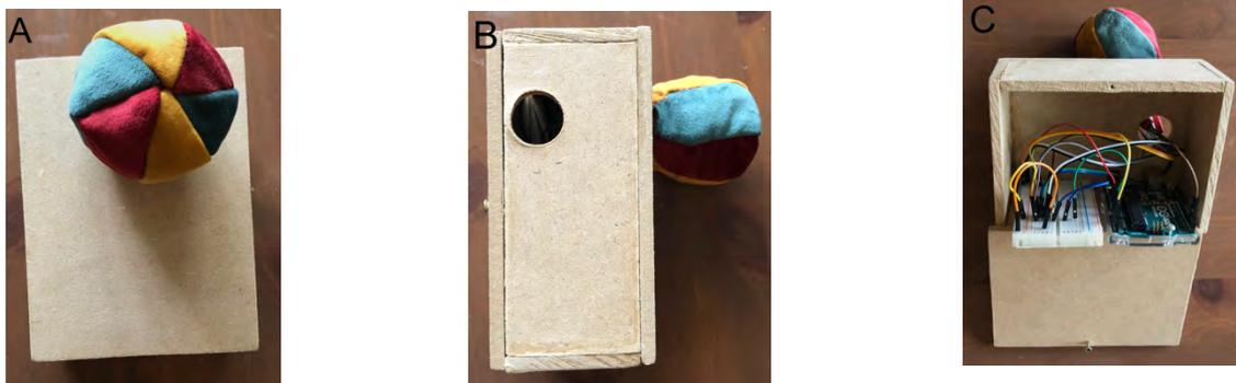
**Figure 40.** *Dispositif expérimental chez les enfants. A. Balle robotisée proposée aux enfants. B. Support en bois sur lequel repose la balle. C. Montage expérimental : les senseurs et les actionneurs sont connectés au breadboard lui-même connecté à l'Arduino Uno, le tout intégré dans la boîte.*
