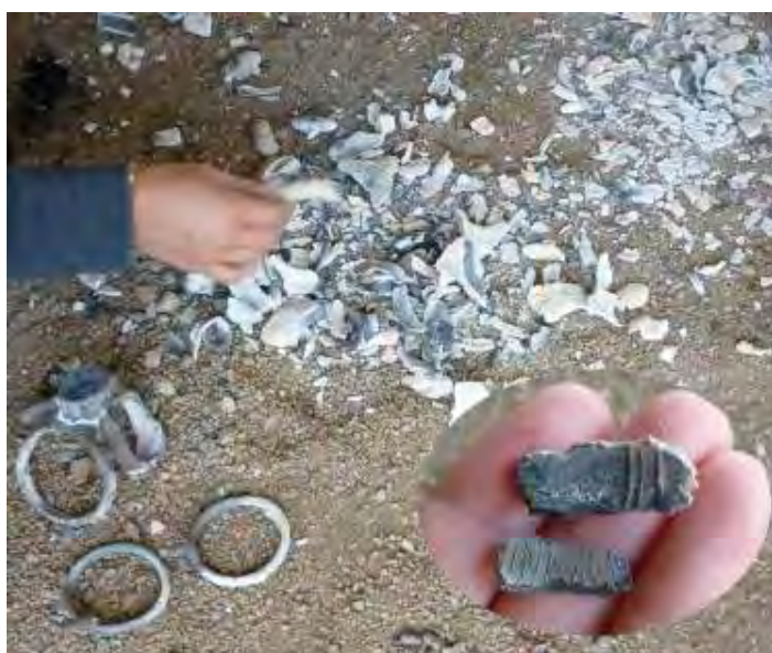
Fig. 261 - Amas des fragments de moules laissés sur place suite au décochage – cliché M. Nordez.
