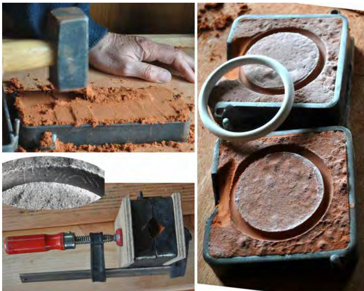
Fig. 242 - Réalisation de moules en sable pour la coulée expérimentale d'anneaux similaires à ceux de Ribécourt-Dreslincourt (Oise) – clichés M. Nordez.
